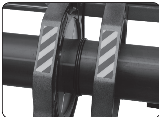
Figur 5: Rørjustering og sammenføjning; der opstår svejsevulster under tryk
