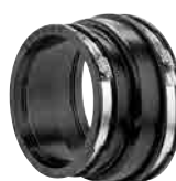
VOTEC RØRKOBLING 155-170x195-220 mm. Til beton. EPDM-AISI316. 0,6 bar, 6Nm BD nr. 19 2561.201
