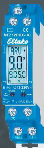
ELTAKO TIMER Multi LCD, 18 funktioner 1 skifte potentialfri 10A 12-230V AC/DC, DIN.
