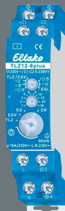
ELTAKO TRAPPEAUTOMAT Med multifunktion 1-30min 1 slutte 16A 8-230V AC/DC, DIN.
